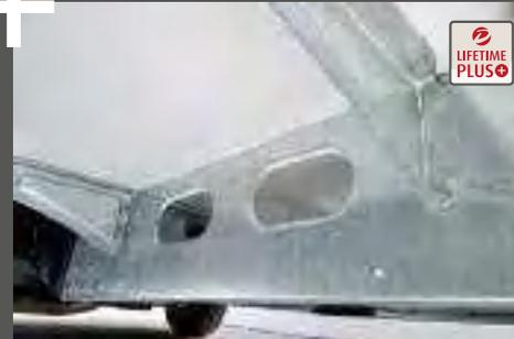
Dethleffs Lifetime-Plus: Der holzfreie Unterboden ist GFR-verkleidet, Seitenwände mit PU Leisten und XPS Isolierung.
