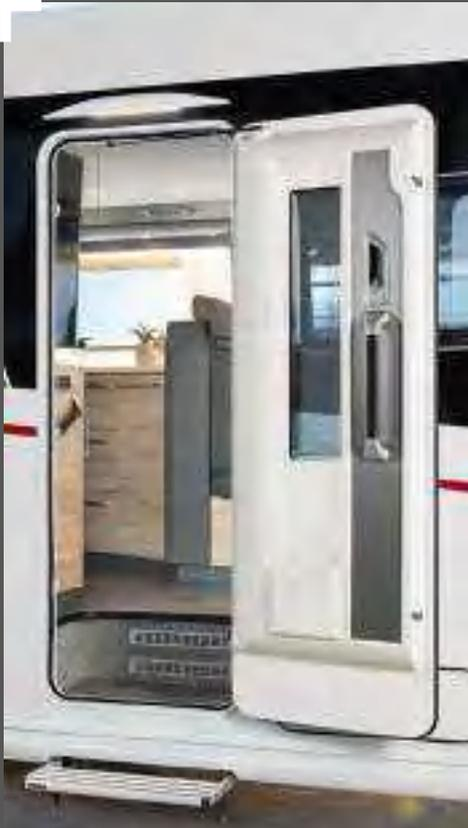
70 cm breite Türe mit Fenster, Zentralverriegelung und elektr. Zuziehilfe.
