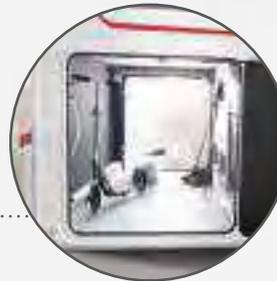
**Lifetime-Plus Aufbau-** konstruktion mit holzfreiem, GFK-verkleideten Unterboden, Seitenwänden mit PU Leisten und XPS Isolierung
