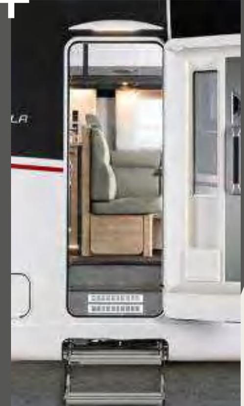
70 cm breite Wohnraumtür mit Fenster, Zentralverriegelung und elektrischer Zuziehhilfe.
