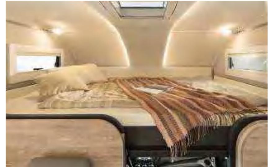
Der Alkoven ist ein komfortabler, abgetrennter Schlafbereich. Mit 215 x 150 cm ist er selbst für Großgewachsene ausreichend dimensioniert. Auch als erweiterter Stauraum wird der Alkoven gerne genutzt. Für einen einfachen Durchgang ins Fahrerhaus ist er hochklappbar.
