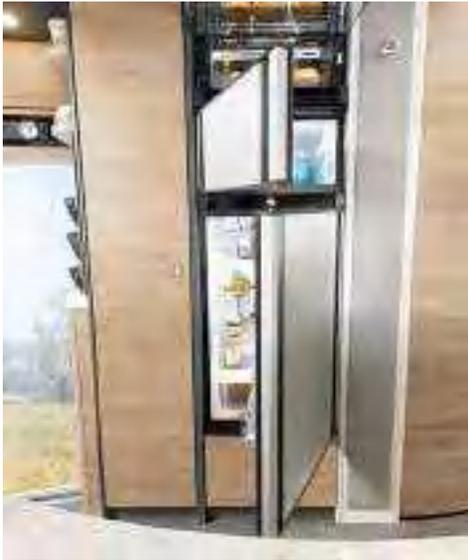
Auf Wunsch bestellbar: 177 l große Kühl-/Gefrierkombination mit Backofen. Die Türen können durch einen Doppelanschlag nach links und rechts geöffnet werden!
